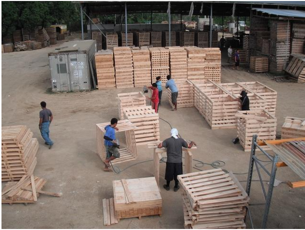
No. 13 輸出用木箱の組み立て作業、木箱の材料はニュージーランドからの輸入 (10月)
